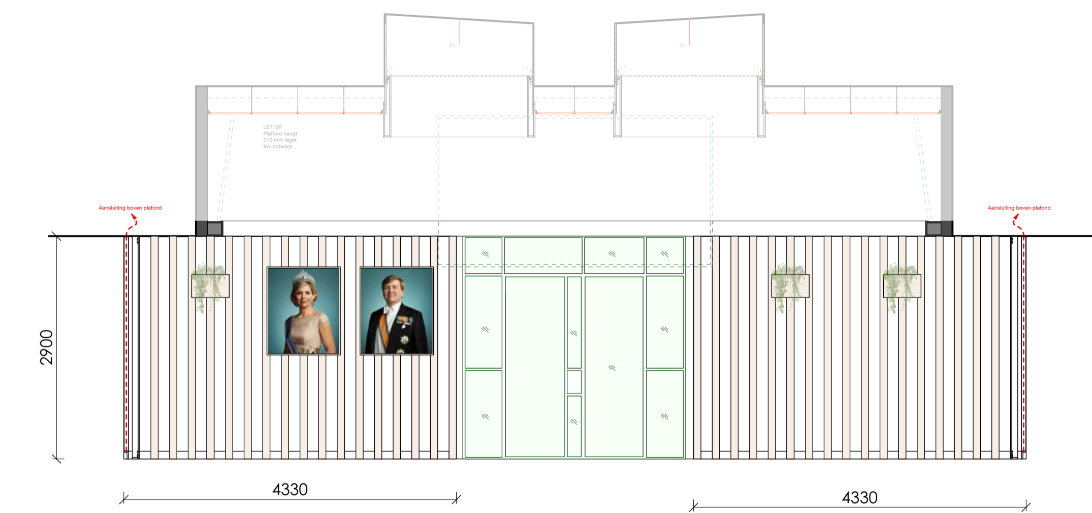
DWARSAANZICHT C-C, LAMELLENWANDEN
