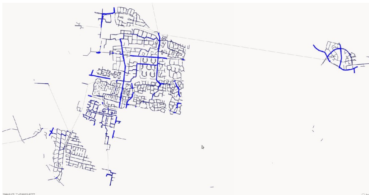
Figuur 1: Risico gestuurd beheer, met “zwaar gewogen riolen” binnen de kern in donkerblauw en minder belangrijke riolen binnen de kern in licht blauw/grijs
