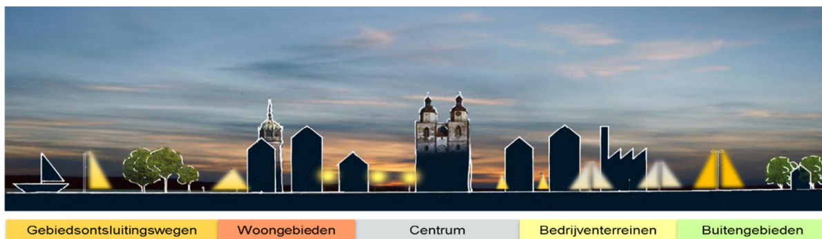
Figuur 3: Dwarsdoorsnede van een gemeente waar per gebied verschillend verlicht wordt
