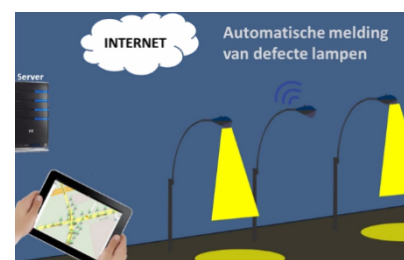
Figuur 4: Werking telemangement-systeem
